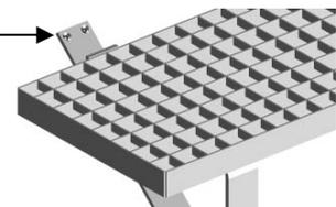
In die Trittelemente mit Hülse werden die Universalpfosten eingesteckt. Je nach entsprechender Wahl müssen die Pfosten mit Geländer- und Mittelholmen versehen werden.
