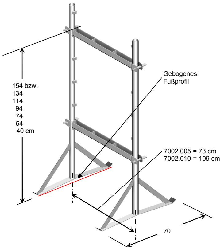
Das Besondere am **Layher Fix-Bock** sind die Einzelteile, die in kürzester Zeit zu einem vollwertigen Bockgerüst zusammen gebaut werden.
